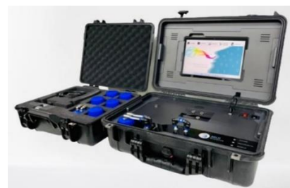
ภาพที่ 2 เครื่องวัดกลิ่นจุ่มก๊อเล็กทรอนิกส์
