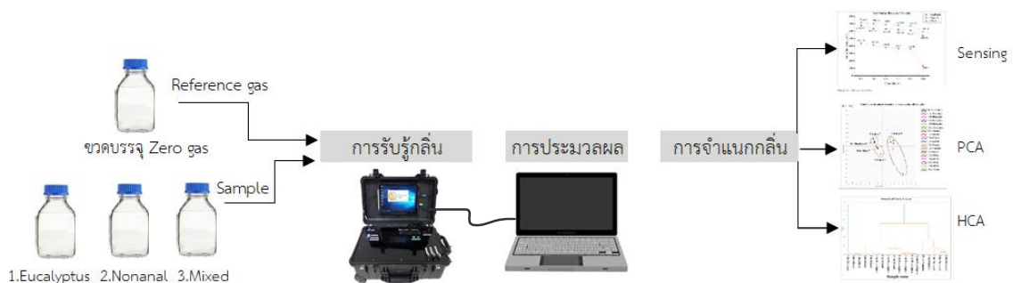
ภาพที่ 3 การทดลองตรวจวัดกลิ่นตัวอย่างด้วยเครื่องจุ่มก๊อเล็กทรอนิกส์
